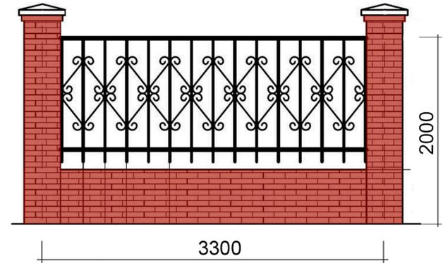
Элементы ограждения между столбами секции могут отличаться дизайном, сохраняя габаритные размеры секции и шаг элементов между столбами.
