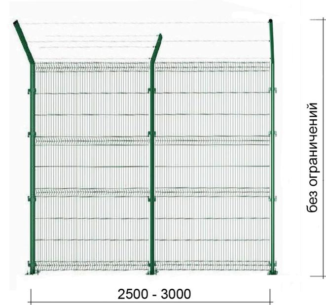
Элементы ограждения между столбами секции могут отличаться дизайном, сохраняя габаритные размеры секции и шаг элементов между столбами.
