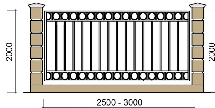
Элементы ограждения между столбами секции могут отличаться дизайном, сохраняя габаритные размеры секции и шаг элементов между столбами.
