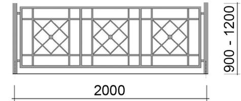
Элементы ограждения между столбами секции могут отличаться дизайном, сохраняя габаритные размеры секции и шаг элементов между столбами.
