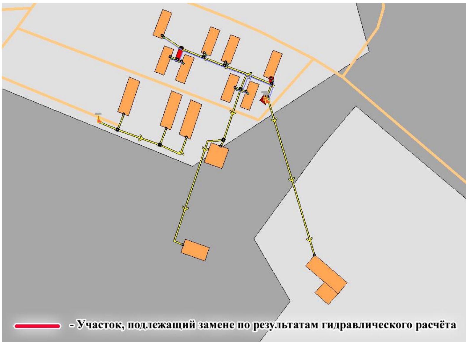
Рисунок 5.25 - Участки тепловой сети котельной №9 п. Котово, подлежащие замене по результатам гидравлического расчета
