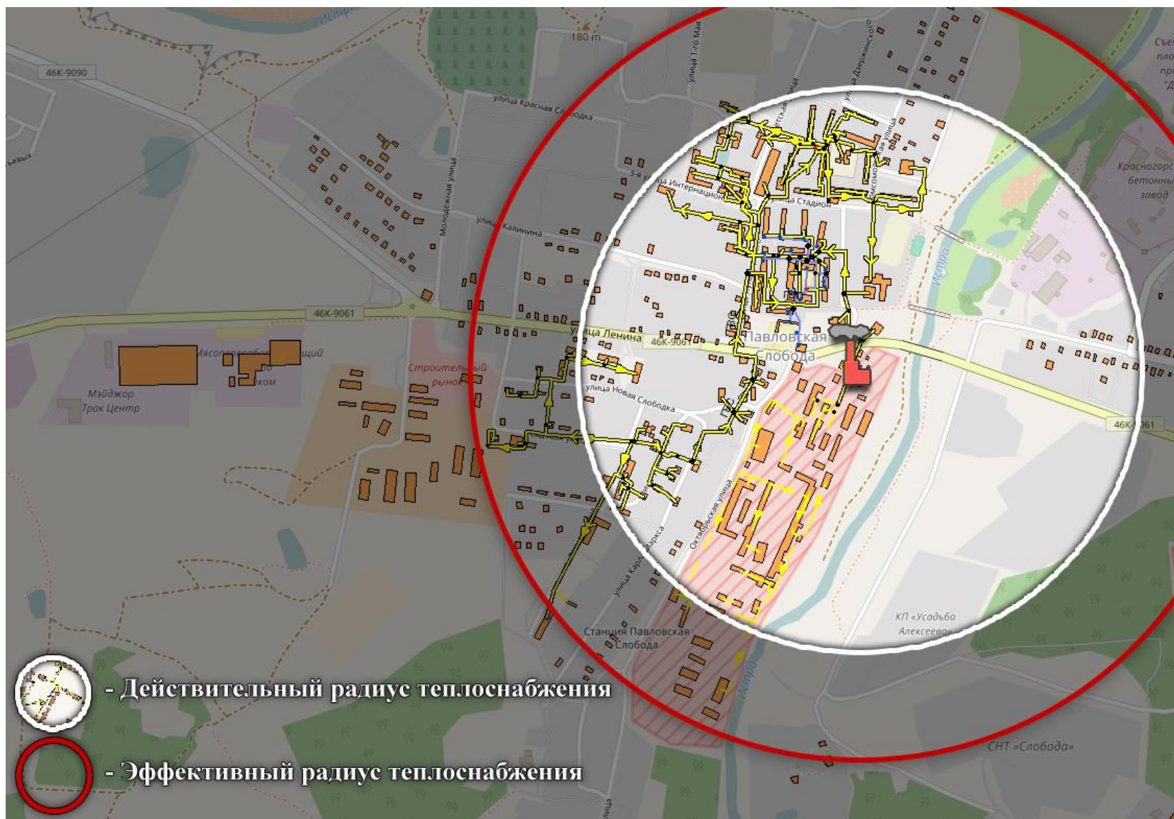
Рисунок 2.18 - Действительный и эффективный радиусы теплоснабжения котельной «Славянка»
