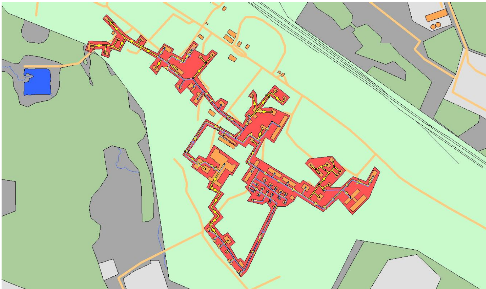
Рисунок 2.55 - Зона действия системы теплоснабжения котельной №2 п. Румянцево ПАО «Истринская теплосеть»
