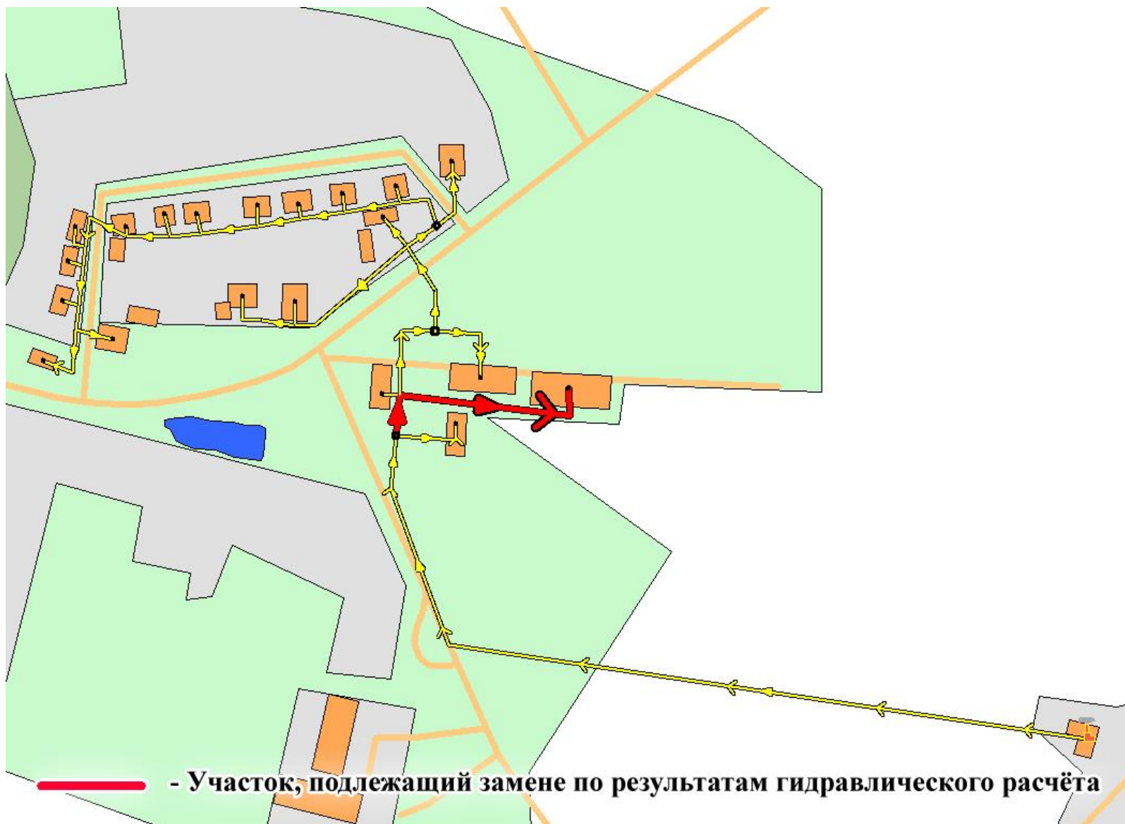
Рисунок 5.39 - Участки тепловой сети котельной д. Савельево, подлежащие перекладке по результатам гидравлического расчёта
