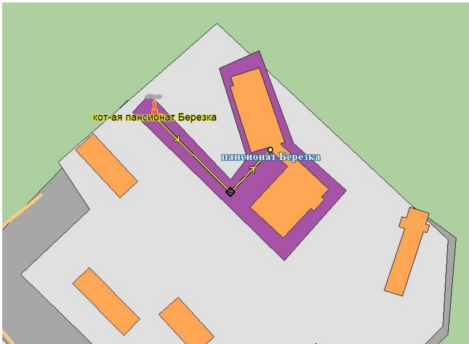
Рисунок 2.79 - Зона действия системы теплоснабжения котельной пансионата «Березка»
