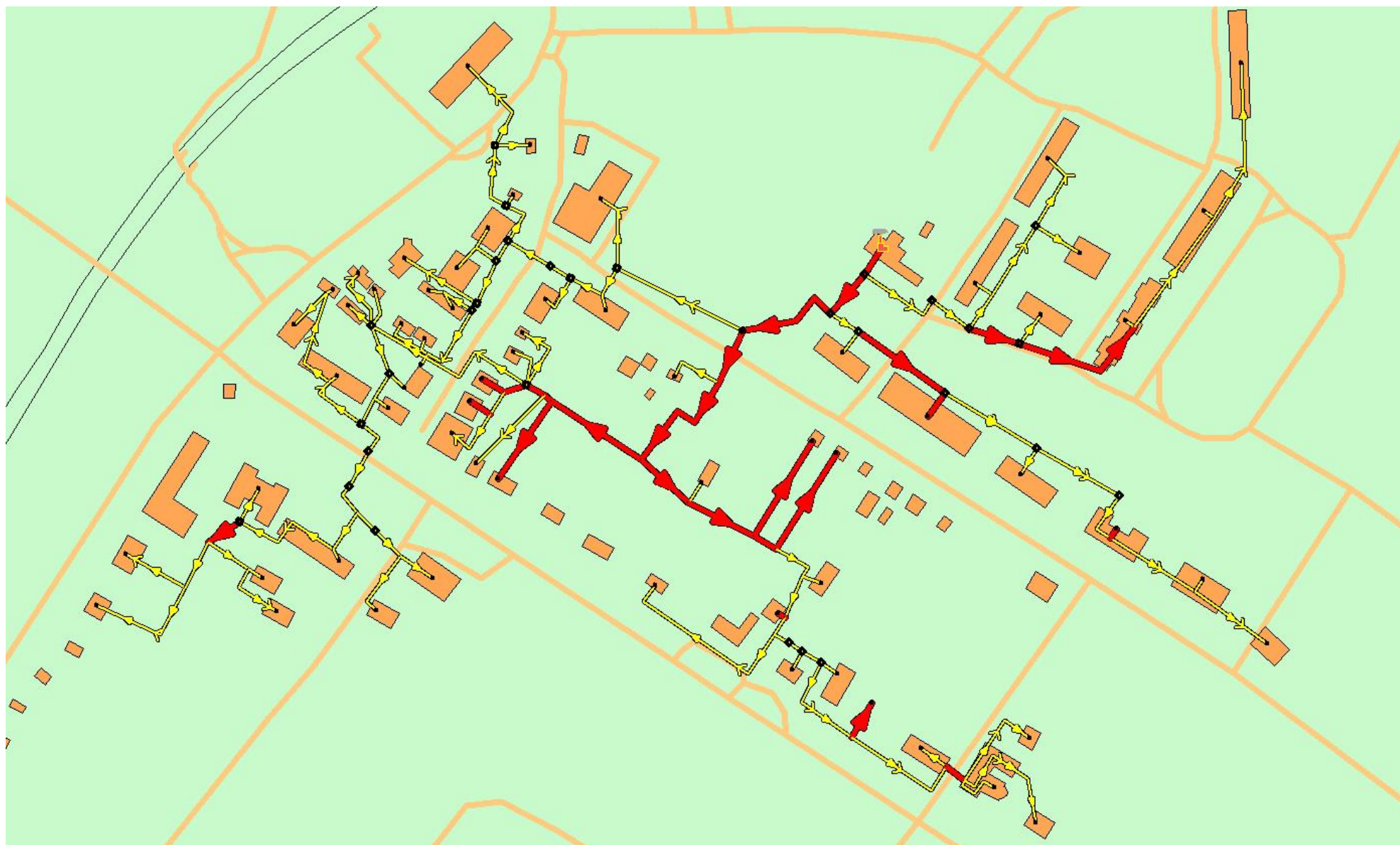
Рисунок 5.29 - Участки тепловой сети котельной №1 с. Новопетровское, подлежащие перекладке по результатам гидравлического расчета
