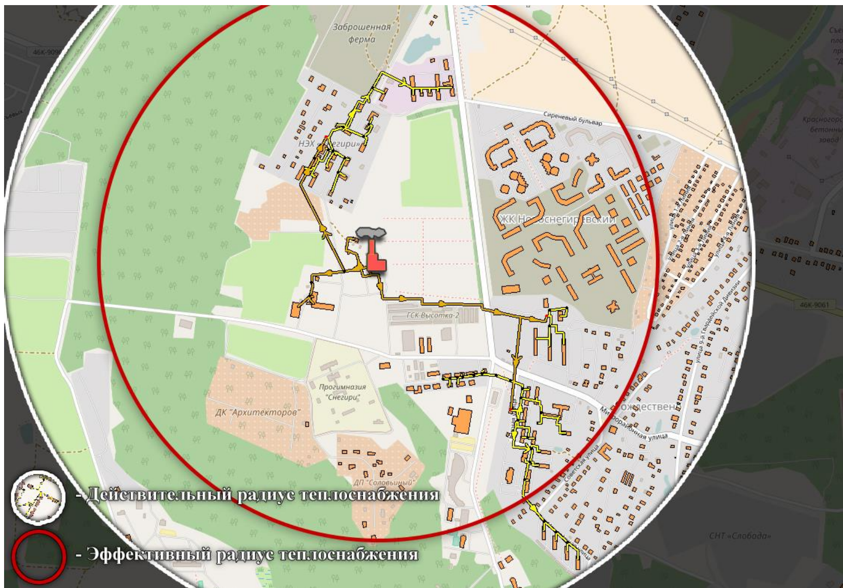
Рисунок 2.19 - Действительный и эффективный радиусы теплоснабжения котельной д. Рождествено
