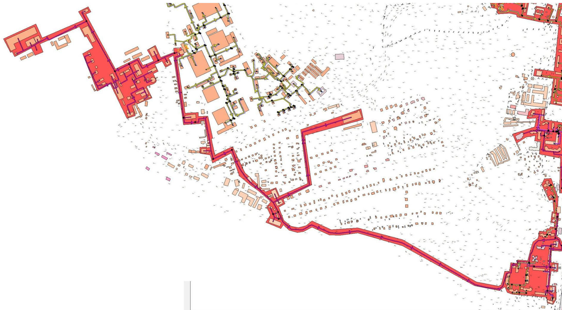
Рисунок 2.68 - Зона действия системы теплоснабжения котельной ГУП «Энергетик ВНИЦ»
