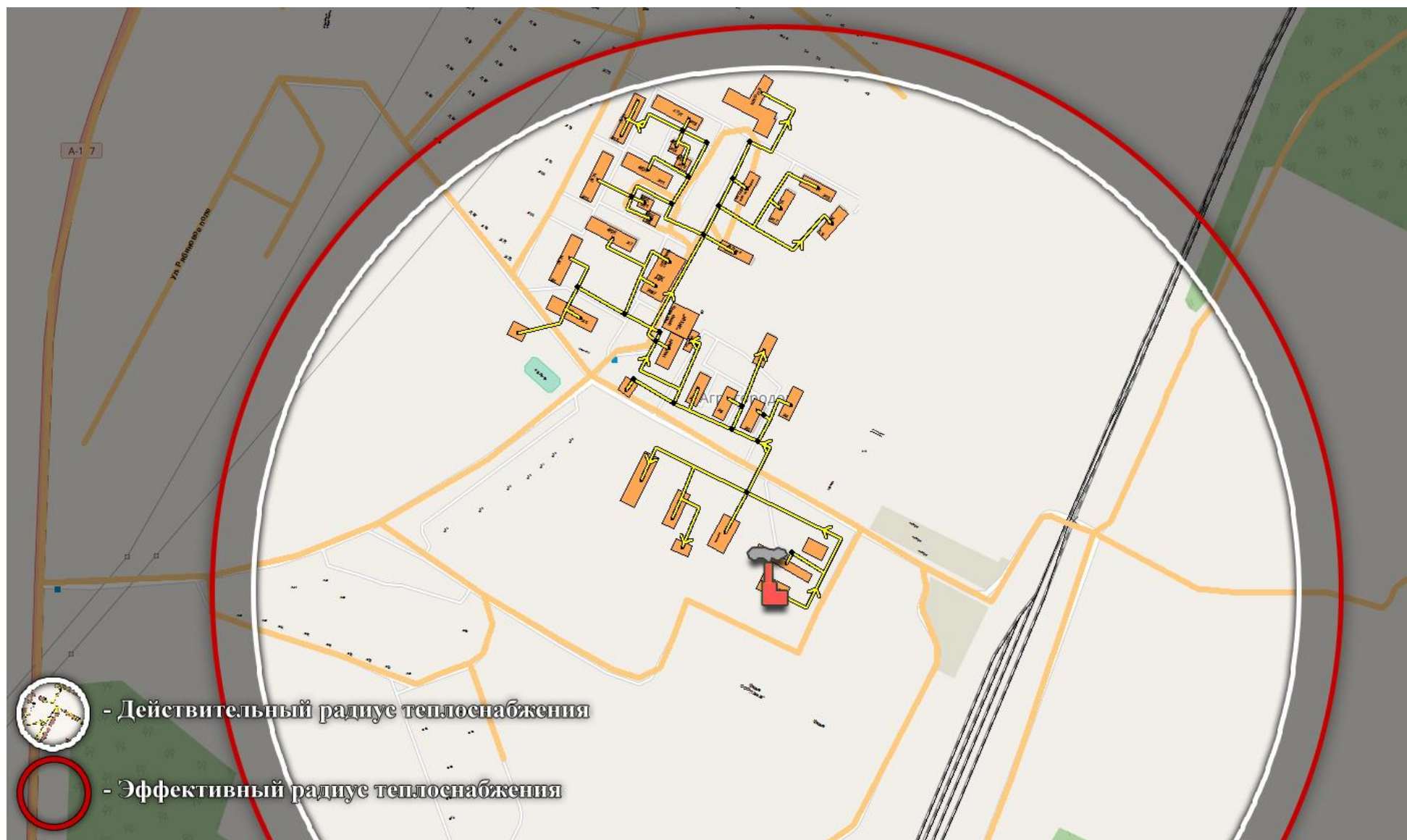
Рисунок 2.23 - Действительный и эффективный радиусы теплоснабжения котельной п. Агрогородок
