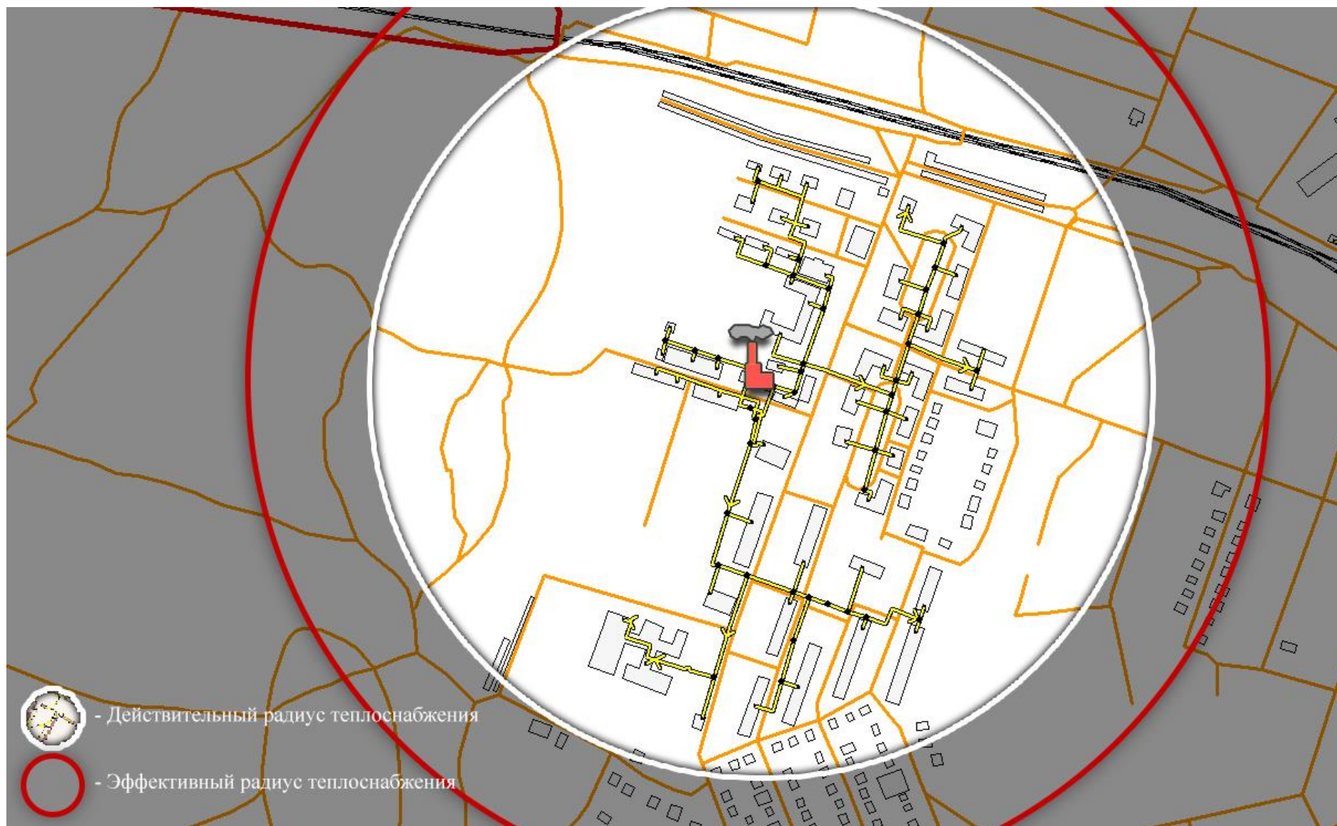
Рисунок 2.8 - Действительный и эффективный радиусы теплоснабжения котельной №4 г. Дедовск
