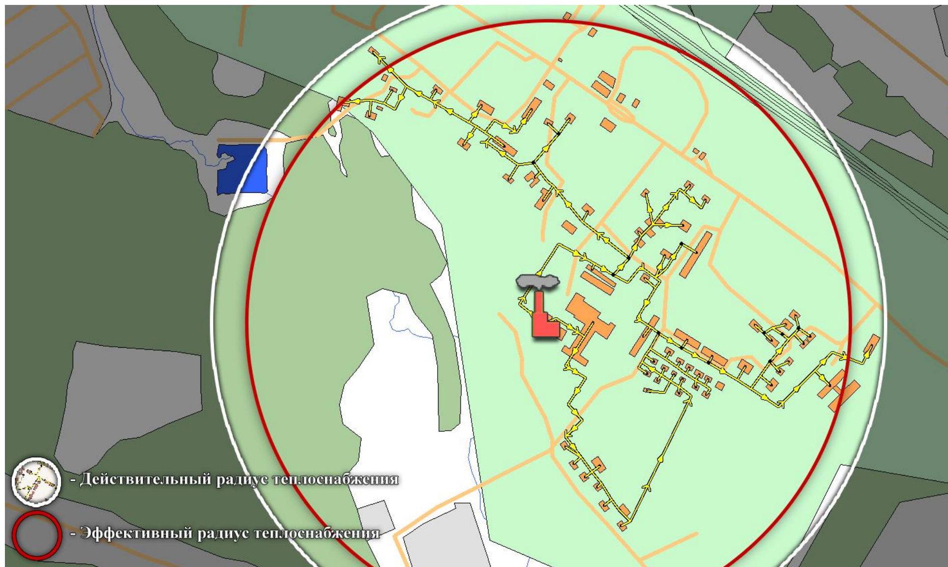
Рисунок 2.15 - Действительный и эффективный радиусы теплоснабжения котельной №2 п. Румянцево
