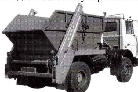
Рис. 4.16. Бункеровоз МКС-3501 на шасси МАЗ-5551А2
