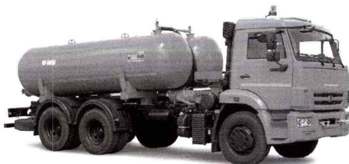
Рис. 5.1. Вакуумная машина КО-505А на шасси КамАЗ-65115-71
