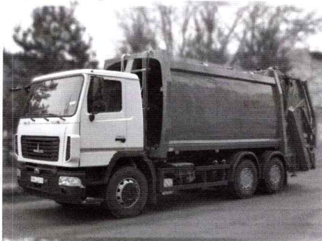
Рис. 4.15. Мусоровоз с задней загрузкой КО-427-90 на базе шасси МАЗ-6312С3
